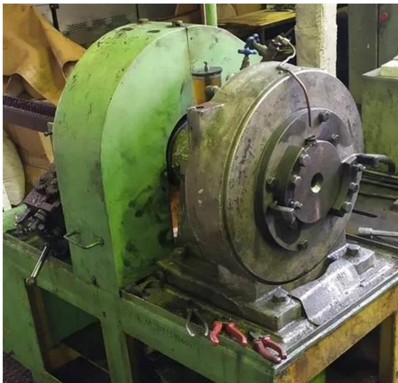
Рисунок 5.5 Внешний вид ротационно-ковочной машины.
