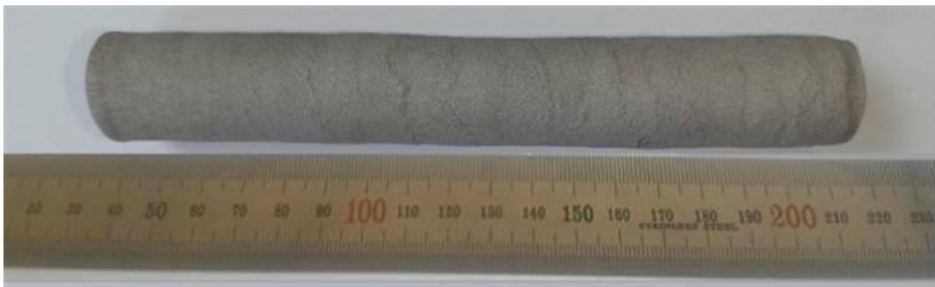
**Рисунок 4.6. Внешний вид компактной заготовки Ti-18Zr-15Nb, полученной вакуумным спеканием 1400 °С с выдержкой 3 часа.**
